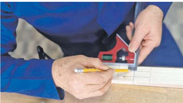
Мал. 11.14. Нанесення лінії розмітки одночасно на дві заготовки
