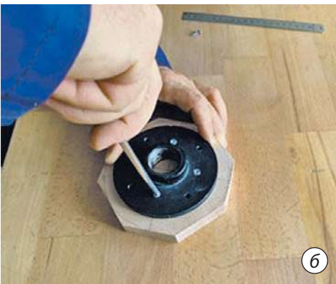
Мал. 10.19. Підготовка до точіння диска
