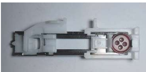
Мал. 14.14. Лапка для виготовлення петлі (автомат)
