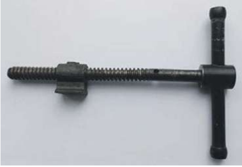
Мал. 9.15. Гвинтовий механізм слюсарних лещат
