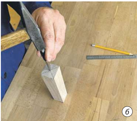
Мал. 10.13. Розмічання центрів заготовки
