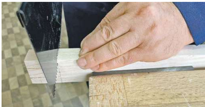
Мал. 11.17. Випилювання заплечиків шипа
