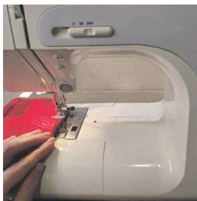
Мал. 7.9. З'єднання в'язаних деталей на швейній машині
