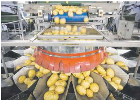
Мал. 16.35. Технологічна лінія із сортування, перероблення та пакування картоплі
