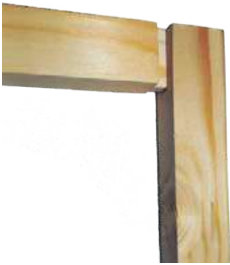
Мал. 11.2. Кутове кінцеве з'єднання
