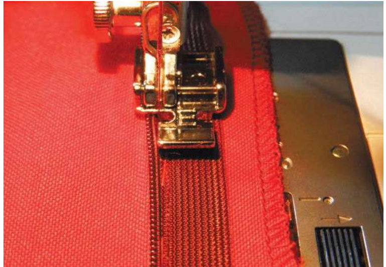
Мал. 14.12. Ушивання застібки «змійка» за допомогою спеціальної лапки
