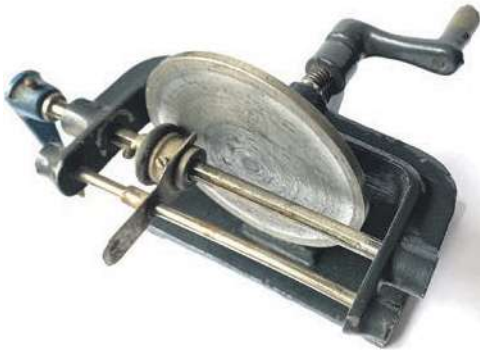
Мал. 9.3. Фрикційна передача з пружиною (модель)
