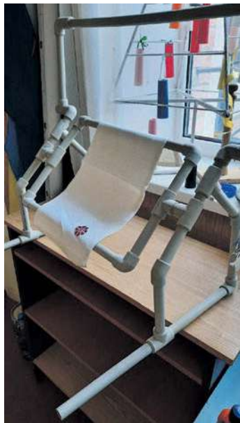
Мал. 12.12. Варіант верстата для рукоділля, виготовленого з труб ПВХ
