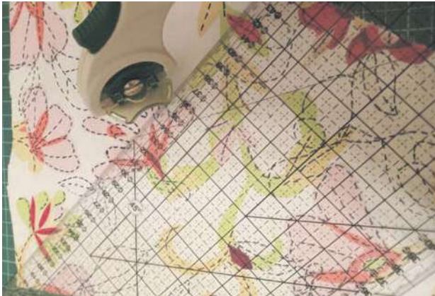
Мал. 13.13. Під час розкроювання часто використовують розкроєний дисковий ніж та килимок із нанесеними розмітками
