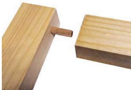
Мал. 11.10. Використання круглого вставного шипа
