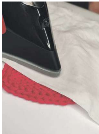
Мал. 7.12. Пропрасування деталей слід виконувати, використовуючи вологу м'яку тканину, аби не пошкодити виріб
