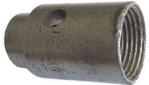
Мал. 10.7. Циліндричний патрон із різьбою
