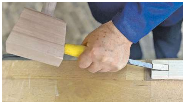
Мал. 11.22. Видалення зрізаної частини деревини
