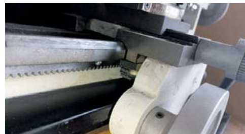
Мал. 9.18 Рейковий механізм токарного верстата по металу
