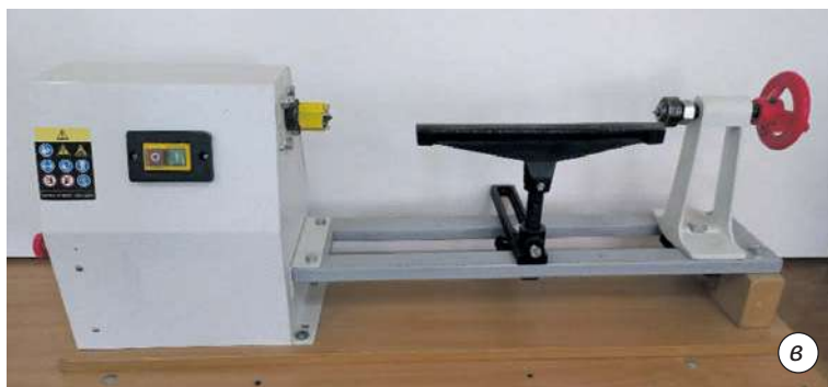
Мал. 10.2. Токарні верстати: а, б — із чавунною станиною; в — без станини
