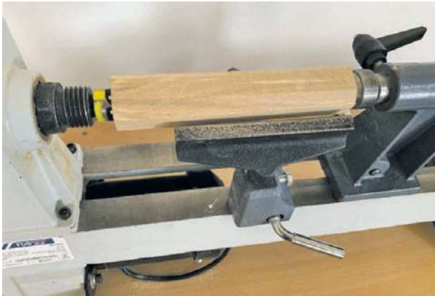
Мал. 10.15. Кріплення заготовки у верстаті
