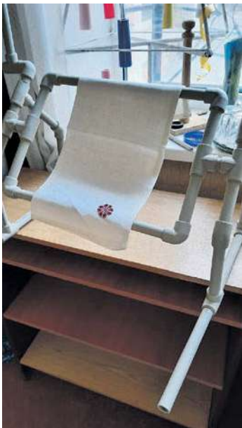
Мал. 12.12. Варіант верстата для рукоділля, виготовленого з труб ПВХ
