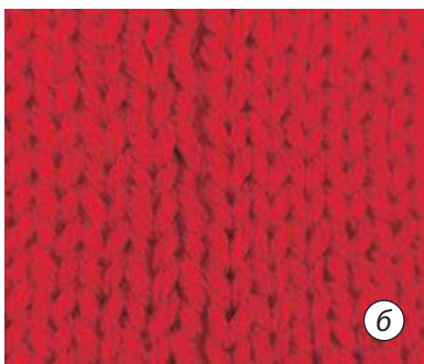
Мал. 7.10. Виворотний (а) та лицьовий (б) бік деталей, з'єднаних за допомогою швейної машини
