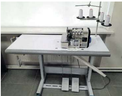
Мал. 14.2. Обметувальна швейна машина (оверлок)
