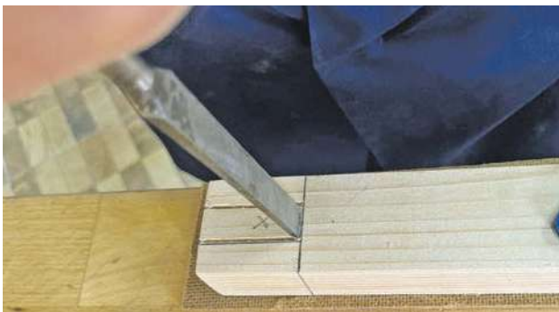
Мал. 11.21. Установлення стамески
